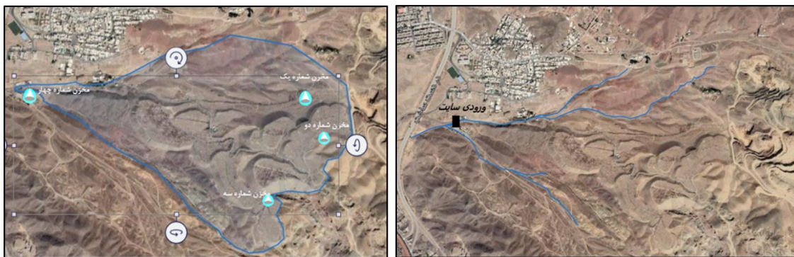
شکل ۵. طراحی شبکه جمع‌آوری آب‌های سطحی شامل آبراهه و کانال
